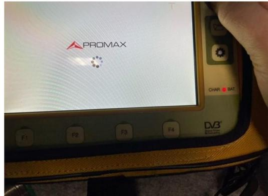
5. Tenere collegato lo strumento alla presa di corrente utilizzando l'alimentatore, per assicurarsi che l'aggiornamento non si interrompa
