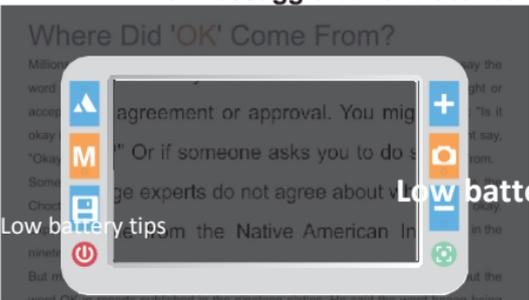
Funzione Batteria scarica (Low Battery Tips). Lo schermo mostra l'icona Low Battery quando la batteria è scarica e la spia di alimentazione lampeggia.
