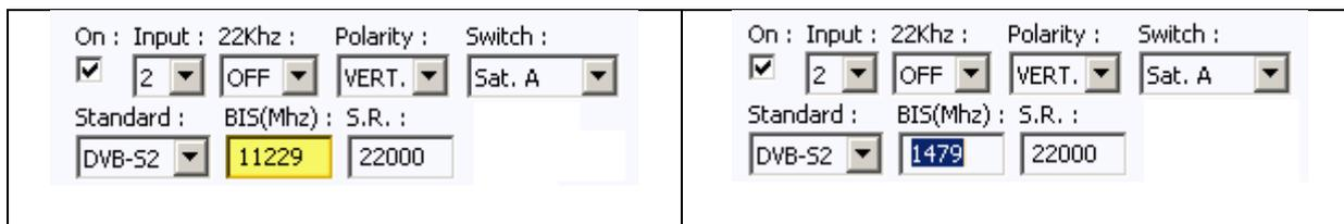
Una volta configurati correttamente i parametri, il segnale verrà acquisito e un valore approssimativo questi parametri verrà specificato in Potenza (Level) e C/N (Quality).
