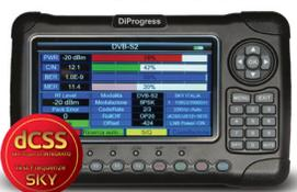
Strumento di misura portatile combinato DiProgress MAX2, con funzioni di misura, visualizzazione immagini e spettro multistandard DVB-T/T2 e DVB-S/S2 con demodulatore MPEG2/4/H265 HEVC per la visualizzazione delle immagini di tutti i nuovi standard TV.
