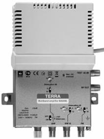
**Amplificatori multibanda da interno, serie pressofusione, MEDIA POTENZA, LTE ready, 20/30dB selezionabile**
