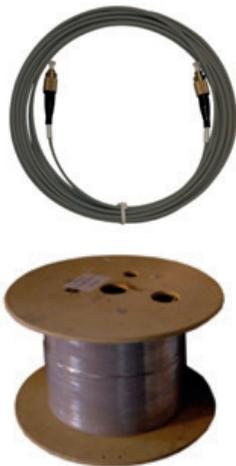
Cavi preconnettorizzati, singola fibra monomodale, con doppio connettore FC/PC, cavo rinforzato con armatura in ferro, resistente ai raggi UV e guaina 3mm in PVC LSZH. Temperatura compresa tra -40°C e +60°C, attenuazione nominale ottica <0,4dB.
