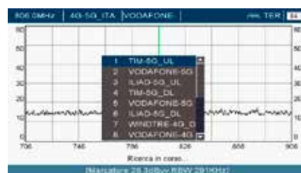
Misure segnali telefonia 4G/5G (potenza e canalizzazione Italia)
