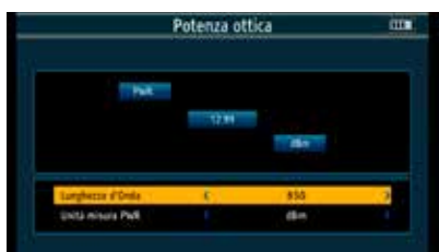
Misurazione Potenza Ottica in dBm o dBW Multi-Lunghezza d'Onda
